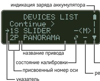
На ЖК-дисплее отображается список приводов и назначенных осей.
